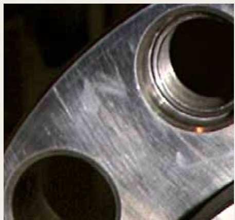
A főelzáró tolózár osztósíkjának ellenőrzése
